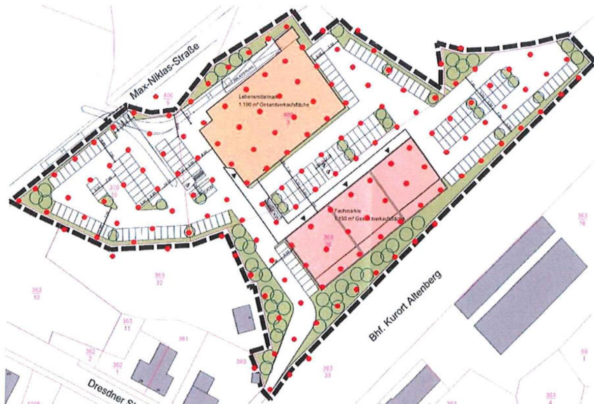
Abb. 2, Lageplan der Messpunkte auf dem Baufeld
